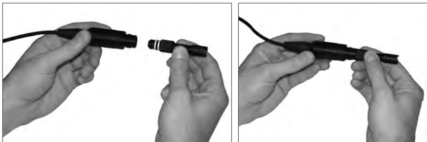
Figura 2. L'immagine a sinistra illustra un sensore pulito e asciutto che viene allineato alla giunzione. A destra, il sensore è stato inserito nella giunzione e viene avvitato nella posizione corretta.
