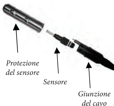
Figura 3. Il sensore si installa direttamente nella giunzione del cavo. Una volta installata, la protezione del sensore proteggerà il sensore stesso durante il campionamento (membrana del tappo DO non mostrata).
