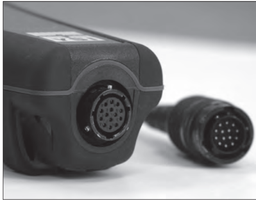
Figura 5. Si noti il connettore con le tacche. I connettori del cavo e dello strumento possono essere collegati solamente quando le sezioni contrassegnate con le tacche sono allineate correttamente.
